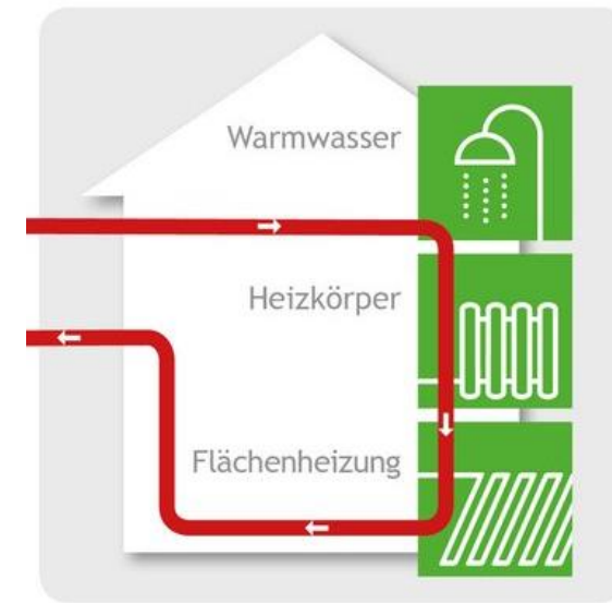
Wärmeverteil- und Speichersystem
